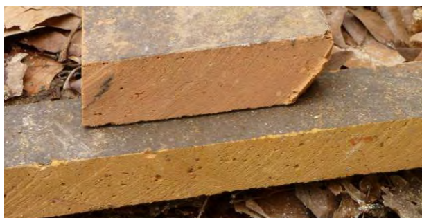
Carreaux de marne (terre argileuse légère, de qualité supérieure).
